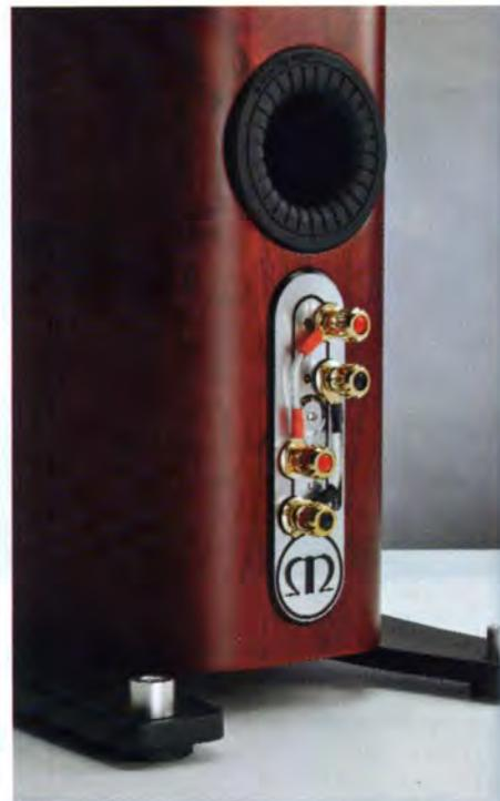
*Il retro del diffusore. Notare il profilo ad ogiva ed il condotto di accordo dotato di numerose rigature interne secondo la tecnica messa a punto dal costruttore e denominata Hi-Ve. Notare i connettori predisposti per il doppio cablaggio e connessi tra loro con spezzoni di cavo.*
