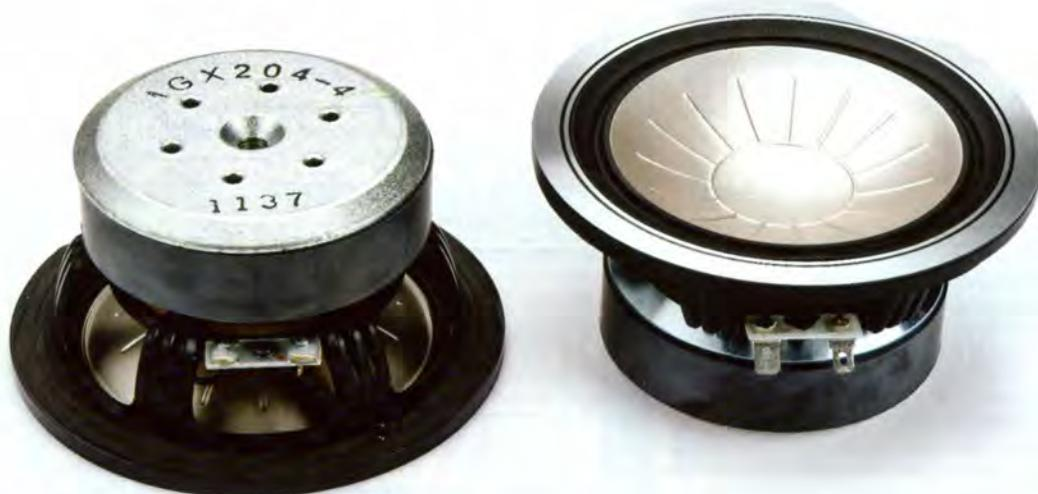
*Il midrange rappresenta la copia rimpicciolita del woofer, con la stessa membrana, la sospensione rovesciata ed il foro centrale per il fissaggio. Notate la flangia frontale tagliata per avvicinare i centri acustici.*
