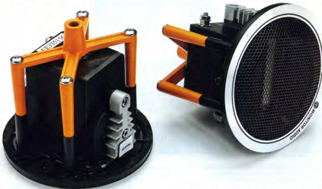
*Il tweeter a nastro utilizza una membrana leggerissima della stessa area di una cupola morbida da 25 millimetri. Notare la camera posteriore, l'alettatura ed il probabile trasformatore di interfaccia con filtro crossover.*
