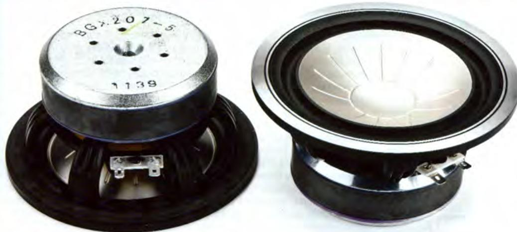
*I woofer hanno la membrana in C-CAM, un trattamento particolare che rende la lega di magnesio ed alluminio estremamente rigida e leggera. Notare le nervature a raggiera ed i sei fori di decompressione col foro centrale utilizzato per il fissaggio al cabinet.*
